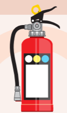
消火器 ★バルブ撤去、二分割 (切断面つぶし品は不可)
